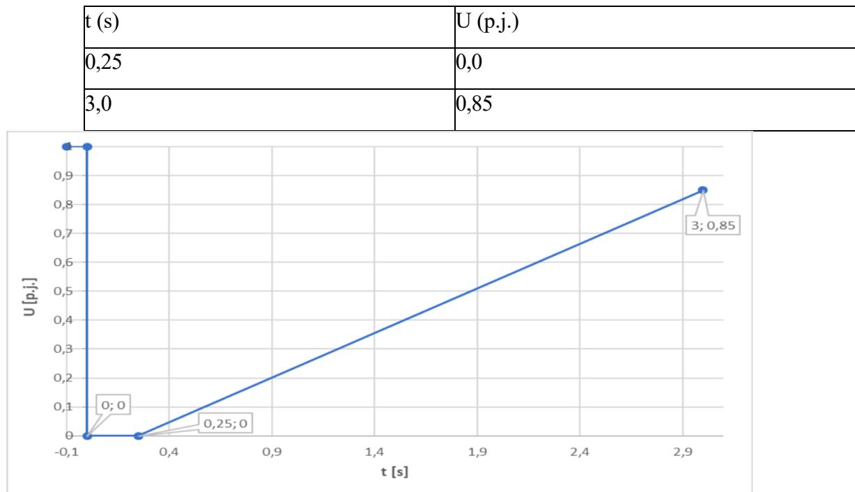
V prípade nesymetrickej poruchy platia rovnaké krvky ako v prípade poruchy symetrickej.
