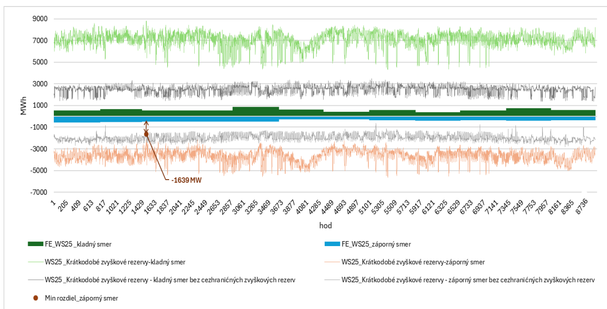
Obr. č. 3.3_2 Pokryvanie kladných (P99,9) a záporných (P0,1) chýb predikcie (FE) krátkodobými zvyškovými rezervami zdrojov flexibility pre WS25 v roku 2030 s uvažovaním a bez uvažovania krátkodobých cezhraničných zvyškových rezerv
